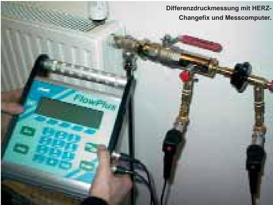
Differenzdruckmessung mit HERZ-Changefix und Messcomputer.
