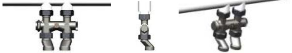
Der Exzenter gleicht unterschiedliche Rohranschlüsse – vor allem bei Einrohr-Tauchventilen (z. B. HERZ-VUA, aber auch andere Hersteller) mit 35 mm oder 40 mm Rohrmittelmaß – aus. Zum Einsatz kommt der Adapter beim Heizkörperaustausch im Zuge einer Sanierung und der Umrüstung auf aktuelle Radiatoren mit einem Rohrmittelmaß von 50 mm in Kombination mit einer Anschlussgarnitur der Serie HERZ-3000.
