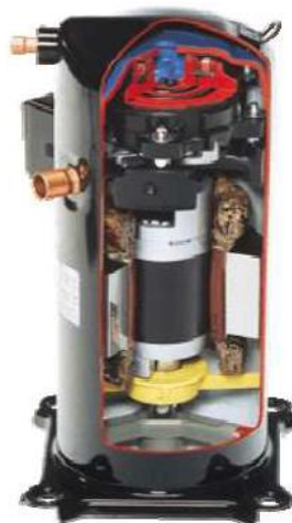
Obr. 5.9: Rez kompresorom Scroll
