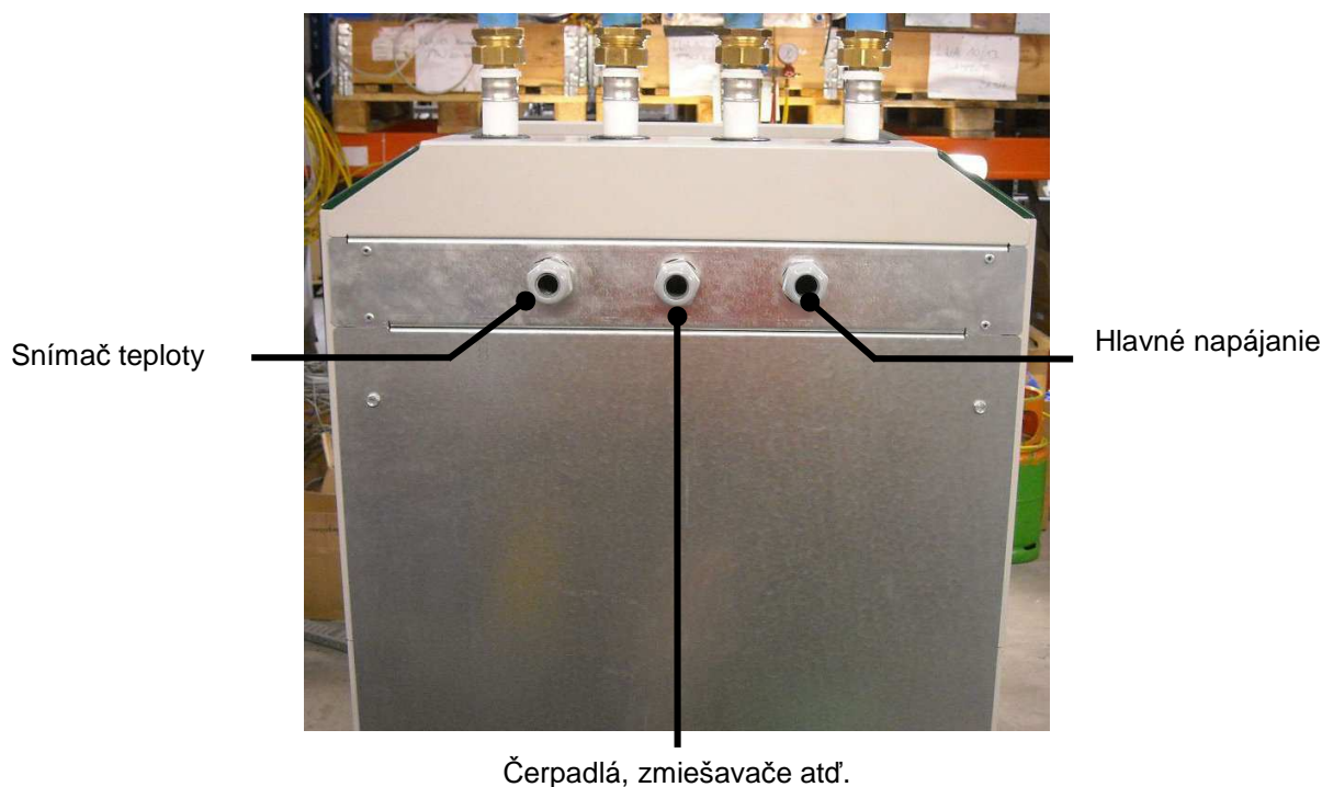
Obr. 3.1: Prechodky na zadnej stene tepelného čerpadla
