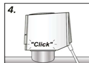
Kolmým tlakom rukou nasadíme termopohon na adaptér, pričom zreteľne počujeme "klik", znak, že termopohon správne zapadol do adaptéra.
